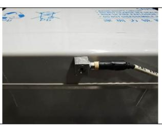
序号 4-8 加速度传感器安装位置(顶部)
