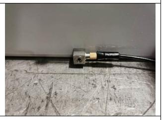
序号 4-6 加速度传感器安装位置(底部)
